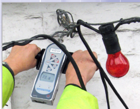
Test trazione su ancoraggi
