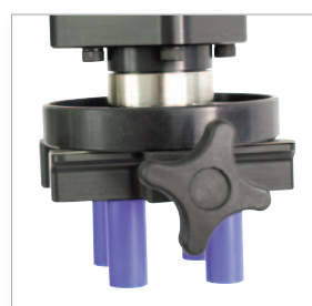
Piastra superiore (da non usare con celle con capacità inferiore a 6 N.m)
